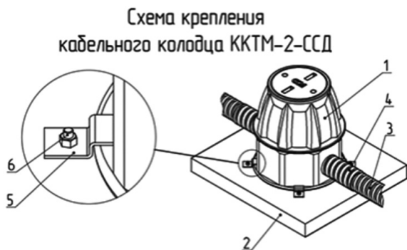
Рисунок Г.6 – Схема крепления кабельного колодца ККТМ-2-ССД
