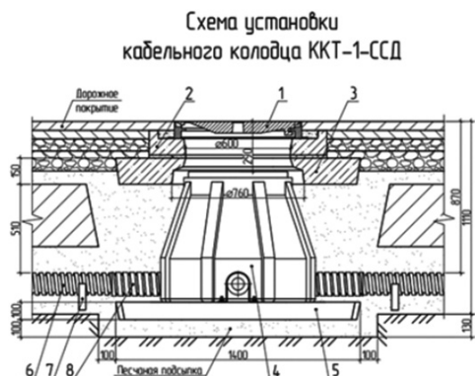
Рисунок Г.7 – Схема установки кабельного колодца ККТ-1-ССД
